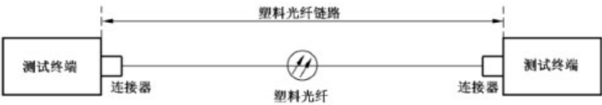
图 3 传输速率测试配置
