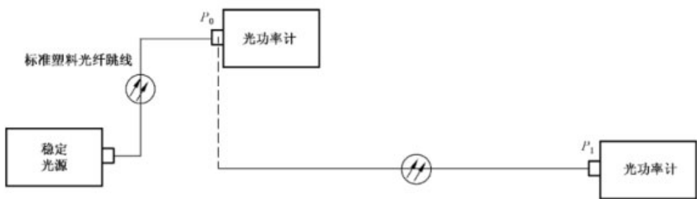
图 2 链路衰减测试配置
